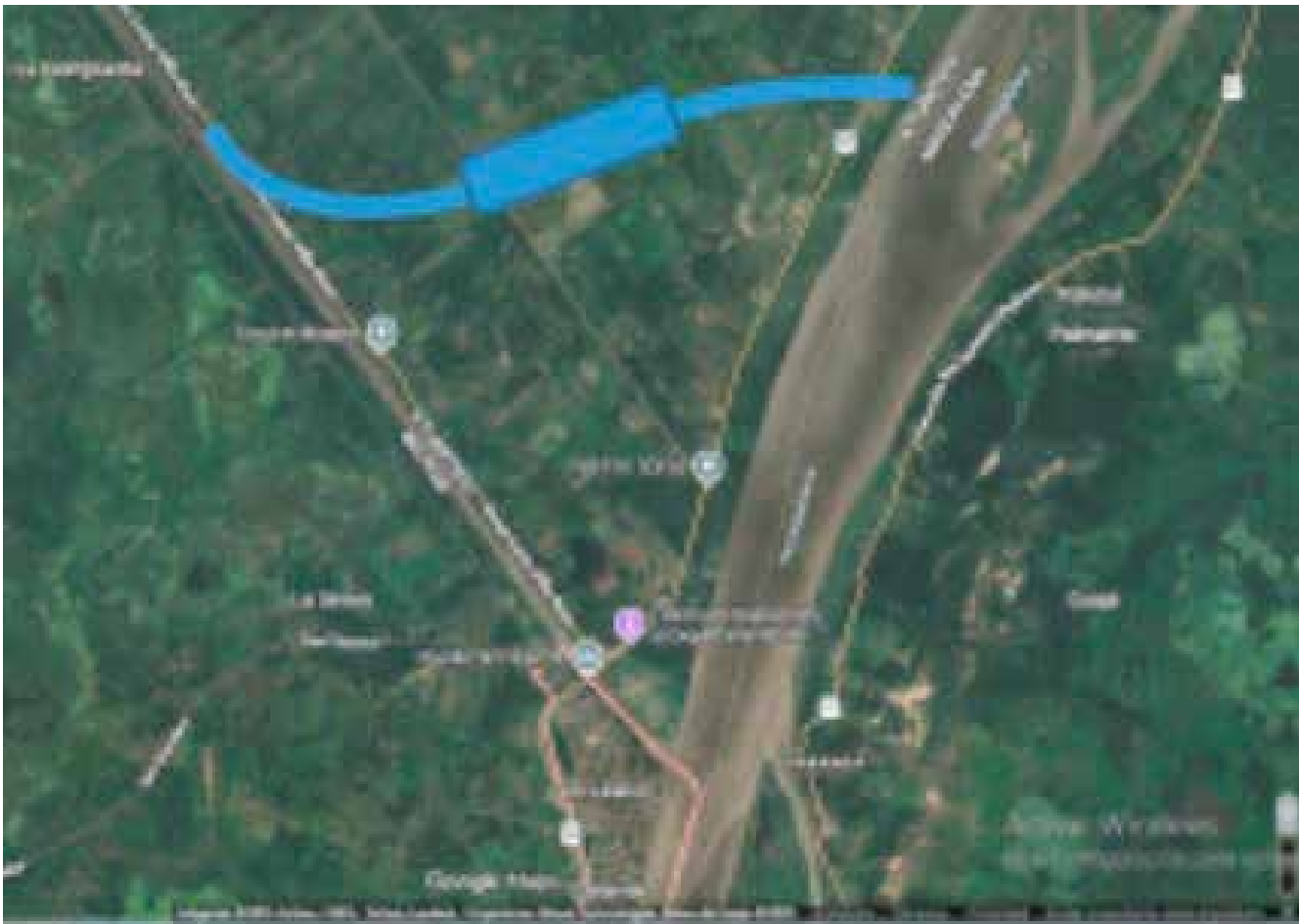
Figura 5: Propuesta de Acceso Alterno al Canal del Dique desde río Magdalena, con cámara de sedimentación y ángulo de conexión > 90° - Diseño Conceptual. Comprendería cierre en Calamar. Fuente: Elaboración propia sobre ortofoto satelital de Google Maps
